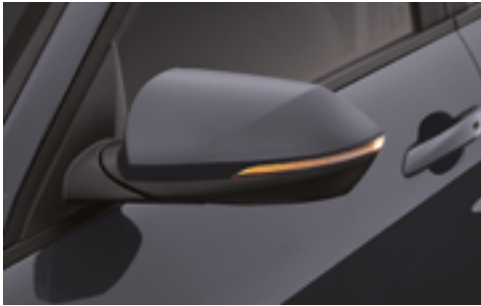
Наружные зеркала заднего вида с обогревом, электроприводом складывания и регулировки, и светодиодными повторителями указателей поворота
